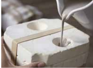
Eingießen der Porzellanmasse Pouring the Porcelain mass Coulée de la masse liquide de Porcelaine
