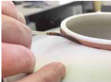
Ziehen eines Goldrandes Drawing a gold edge Dessiner un bord en or
